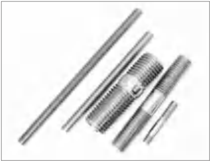
牙棒STUDS 材质 Material: 304、316 规格 Size: M3—M42 标准 Standard: DIN976、GB901、GB898、GB899、GB897、GH20634、U型螺栓
